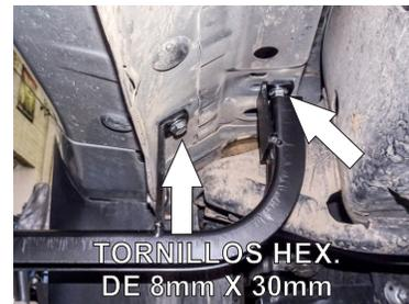
1.- Identifique los tornillos existentes por debajo de la carrocería, en la parte frontal lateral y proceda a retirarlos. Presente el **Herraje Frontal "A"** y fíjelo a los barrenos con los tornillos de 8mm X 30mm junto con sus respectivas rondanas plana y de presión.
