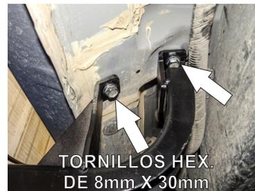
2.- Igualmente ubique los tornillos existentes por debajo de la carrocería, por la parte media y proceda a retirarlos. Presente el **Herraje Intermedio "B"** y fíjelo a los barrenos con los tornillos de 8mm X 30mm junto con sus respectivas rondanas plana y de presión.
