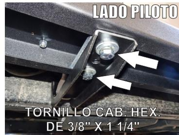
4.- Presente el estribo sobre los herrajes e introduzca el **Herraje Auxiliar "C"** por dentro del estribo y deslicelo manualmente hasta que coincida con los barrenos de los **Herrajes "A" y "B"**, enseguida fije los herrajes en manera de sandwich utilizando los tornillos de 3/8" X 1 1/4" junto con sus respectivas rondanas plana y de presión.
