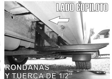
7.- Enseguida retire la guía con precaución evitando que el tornillo caiga dentro del chasis y presente el **Herraje Intermedio "B"** en dicho tornillo, fijándolo con las rondanas y tuerca de 1/2".
