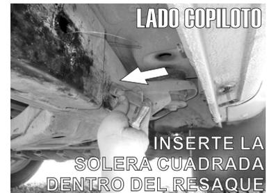
1.- Identifique los resaque rectangular por el costado del chasis, en dirección de la llanta frontal del vehículo e inserte una guía de micro alambre del resaque frontal hacia el resaque posterior como se indica en las fotografías anexas.
