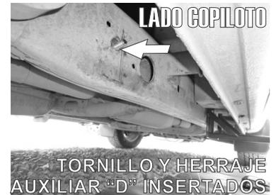
8.- Ubique los barrenos al costado del chasis, en dirección de la llanta posterior del vehículo.
