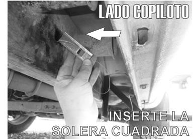
5.- Ubique el resaque rectangular por el costado del chasis en dirección de las dos puertas del vehículo y rosque una guía de micro-alambre con un tornillo cab. coche e inserte la guía con una Solera Cuadrada.
