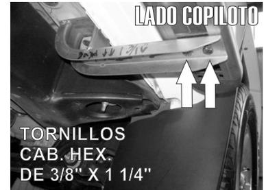
3.- Presente el estribo sobre los herrajes e introduzca el **Herraje Auxiliar "C"** por dentro del estribo y deslícelo manualmente hasta que coincida con los barrenos de los **Herraje Principales "A" y "B"**, enseguida fije los herrajes en manera de sandwich utilizando los tornillos de 3/8" X 1 1/4".
