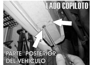
1.- Identifique los tornillos plásticos por debajo de la carrocería de su vehículo y proceda a retirarlos con un desarmador plano, para dejar los barrenos roscados al descubiertos.
