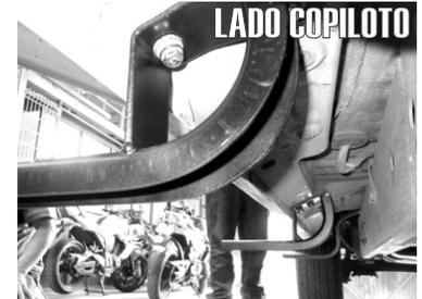
3.- Presente el **Herraje Frontal "A"** en los barrenos frontales del vehículo y fíjelo con los Tornillos de 8mm X 30mm. De igual manera fije los **Herrajes Intermedios y Posteriores "B"** en los barrenos intermedios y posteriores de vehículo.
