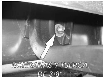
5.- Inserte el Herraje Frontal "A" dentro del tornillo insertado y retire la guía manualmente evitando que el tornillo caiga dentro del chasis y fije el Herraje en dicho tornillo con las rondanas y tuerca de 3/8".
