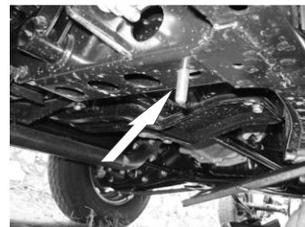
7.- Identifique los barrenos del puente transversal que esta soldado con el chasis e inserte en forma de giro un Tornillo "T" de 7/16" X 1 1/2" del barreno central hacia el barreno lateral.
