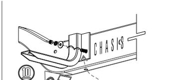
10 Presente el Herraje Principal "C" en el tornillo insertado y retire la guía de micro-alambre evitando que el tornillo caiga dentro del chasis y fije el Herraje con las rondanas y tuerca de 3/8"
