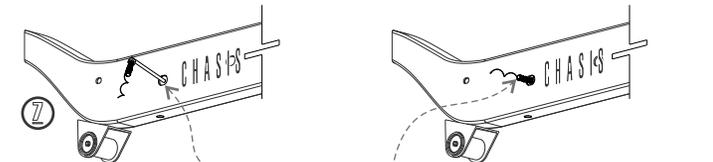
7 Rosque la guía de micro-alambre con el tornillo especial (de la varilla soldada) e insertelo en el barreno posterior del chasis
