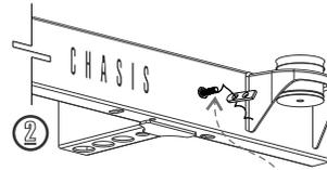
2 Inserte la solera especial dentro de la guía de micro-alambre y deslicela hasta dentro del chasis, por el barreno existente (Al igual que el tornillo anterior)
