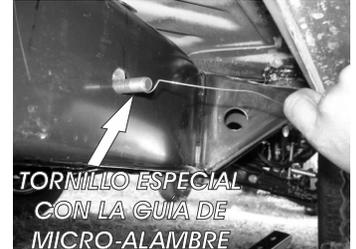
4.- Después jale la guía de micro-alambre hacia arriba y hacia abajo, hasta que se centre con el barreno de la solera insertada y jale poco a poco la punta del tornillo hacia fuera como se muestra en la fotografía.
