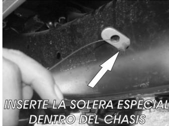
INSERTE LA SOLERA ESPECIAL DENTRO DEL CHASIS
