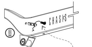
8 Inserte la solera especial dentro de la guía de micro-alambre y deslicela hasta dentro del chasis, por el barreno existente (Al igual que el tornillo anterior)
