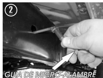
2.- Rosque la guía de micro-alambre con Tornillo especial de 3/8" X 1 1/2" con la varilla soldada e inserte el tornillo dentro del chasis por el barreno existente.
