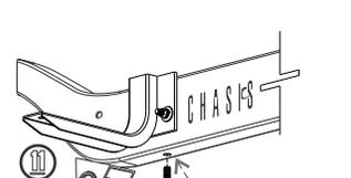
11 Identifique el barreno por debajo del chasis e inserte el esparrago de 7/16" X 6 1/2" de abajo hacia arriba fijando el Herraje con las rondanas y tuercas de 7/16"
