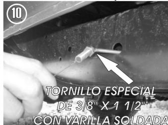
9.- Identifique el barreno ubicado sobre el chasis por la parte posterior del vehículo.
