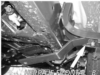
6.- Enseguida fije el Herraje Frontal "B" por debajo del Herraje Frontal "A" con el tornillo de 3/8" X 1", como se muestra en la fotografía.
