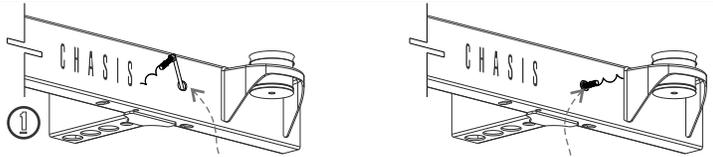
1 Rosque la guía de micro-alambre con el tornillo especial (de la varilla soldada) e insertelo en el barreno frontal del chasis
