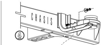
4 Presente el Herraje Frontal "A" en el tornillo insertado y retire la guía de micro-alambre evitando que el tornillo caiga dentro del chasis y fije el Herraje con las rondanas y tuerca de 3/8"
