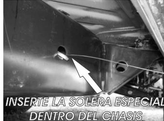
3.- Enseguida coloque la solera del tornillo "T" dentro de la guía de micro-alambre y deslicela manualmente hasta insertarla por el mismo barreno existente dentro del chasis.
