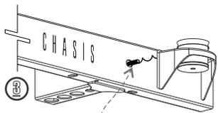
3 Jale la guía de micro-alambre lenta y ondulatoriamente hasta sacar la punta del tornillo por fuera del chasis
