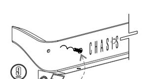
9 Jale la guía de micro-alambre lenta y ondulatoriamente hasta sacar la punta del tornillo por fuera del chasis
