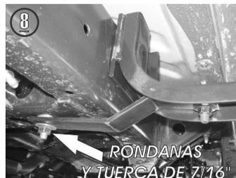
8.- Fije el otro extremo del Herraje Frontal "B" con el tornillo "T" especial que inserto utilizando las rondanas y tuerca de 7/16".
