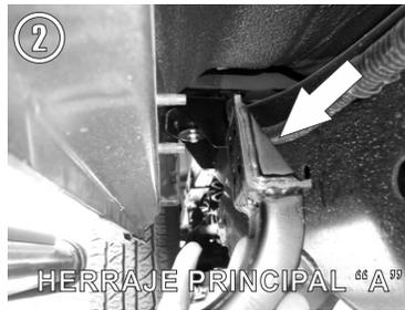
2.- Presente el Herraje Principal "A" en los tornillos existentes y fijelos con las rondanas de 5/16" y las tuercas de 8 mm.
