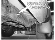
2.- Enseguida rosque un Tornillo "T" esp. de 7/16" con la guía de micro-alambre insertada y jale la guía del otro extremo para colocar el tornillo especial dentro del barreno inicial.
