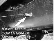
7.- Enseguida inserte la guía de micro-alambre con una Solera especial y deslicela manualmente hasta insertarla por el barreno del chasis y jale la guía de micro-alambre poco a poco, hasta que la punta del tornillo quede hacia fuera como se muestra en la fotografía.
