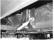
8.- Inserte la guía con el barreno del **Herraje Posterior** "B" y retire la guía manualmente evitando que el tornillo caiga dentro del chasis y fije el Herraje con dicho tornillo utilizando las rondanas y tuerca de 3/8".
