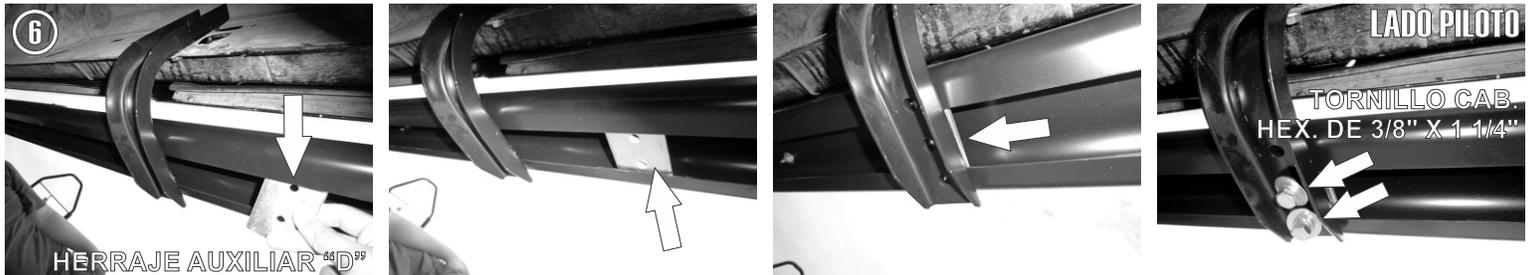
6.- Una vez que se han instalado los Herrajes anteriores presente el estribo del Lado Piloto e inserte el **Herraje Auxiliar "B"** por la parte posterior colocándolos en coincidencia de cada herraje y fijándolos con los Tornillos de 3/8" x 1 1/4" y Rondanas de 3/8".
