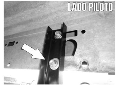
4.- Tal como el Herraje Frontal, instale el Herraje Central (Herraje Principal "A") de igual forma, insertando una Grapa y un Tornillo Cab. Hex. de 5/16" X 1" para el Barreno superior y un Tornillo Cab. Hex. de 3/8" X 1 1/4" para el Barreno Inferior.
