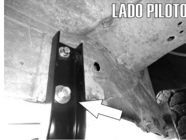
3.- Ahora introduzca en el barreno inferior del Chasis y el Herraje un Tornillo Ca. Hex. de 3/8" X 1 1/4" y fíjelo con sus respectiva Tuerca y Rondanas de 3/8"
