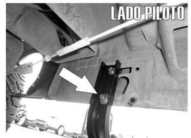
5.- Tal como el Herraje Frontal, instale el Herraje Trasero (Herraje Principal "A") de igual forma, insertando una Grapa y un Tornillo Cab. Hex. de 5/16" X 1" para el Barreno superior y un Tornillo Cab. Hex. de 3/8" X 1 1/4" para el Barreno Inferior.
