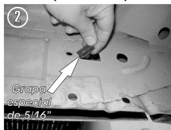
2.- Coloque la Grapa Especial del resaque rectangular hacia el barreno lateral.
