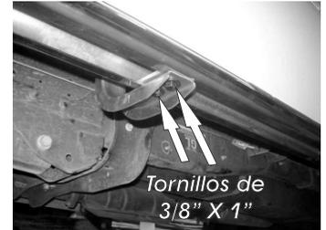
7.- Presente el estribo sobre los herrajes Principales e introduzca los **Herrajes Auxiliares "B"** por dentro del estribo y deslicelos manualmente hasta que coincidan con los barrenos de los **Herrajes Principales "A"**, enseguida fije los herrajes en manera de sandwich utilizando los tornillos de 3/8" X 1".
