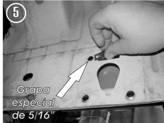
5.- Coloque la Grapa Especial del resaque rectangular hacia el barreno lateral.
