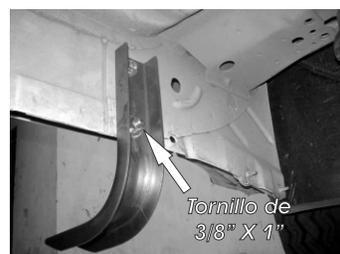
3.- Fije el Herraje Principal "A" en la grapa que inserto con anterioridad, utilizando el tornillo 5/16" X 1" y enseguida fijelo con el barreno inferior de la carrocería, utilizando el tornillo de 3/8" X 1".
