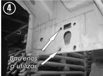
4.- Identifique los barrenos existentes por debajo de la carrocería de su vehículo.
