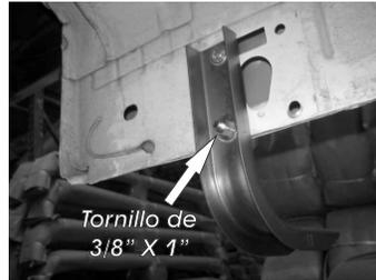
6.- Fije el Herraje Principal "A" en la grapa que inserto con anterioridad, utilizando el tornillo 5/16" X 1" y enseguida fijelo con el barreno inferior de la carrocería, utilizando el tornillo de 3/8" X 1".
