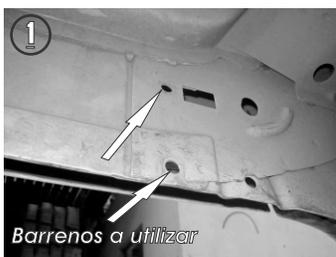
1.- Identifique los barrenos existentes por debajo de la carrocería de su vehículo.
