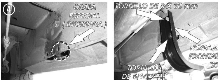
4.- De igual forma Fije UNA grapa en el Primer Barreno Inferior de la carrocería, en dirección de la llanta posterior y fije el **Herraje Principal "A"** con el tornillo de 8 X 30 mm y en la parte inferior con el tornillo de 5/16" X 1" y las rondanas de 5/16".
