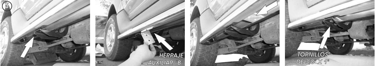
5.- Presente el estribo sobre los herrajes e introduzca el **Herraje Auxiliar "B"** por dentro del estribo y deslicelo manualmente hasta que coincida con los barrenos de los **Herrajes Principales "A"**, enseguida fije los herrajes en manera de sandwich utilizando los tornillos de 3/8" X 1".
