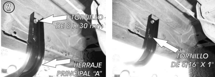
2.- Presente el **Herraje Principal "A"** y fíjelo en el barreno superior ( roscado ) con el tornillo de 8 X 30 mm y en la parte inferior fíjelo con la grapa que inserto utilizando el tornillo de 5/16" X 1" y las rondanas de 5/16".
