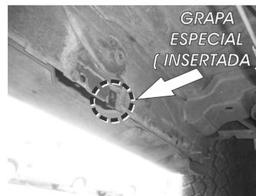
1.- Identifique los barrenos existentes por debajo de la carrocería del vehículo, en dirección de la llanta frontal e inserte UNA grapa especial en el Primer Barreno Inferior, centrandola manualmente sobre el barreno.
