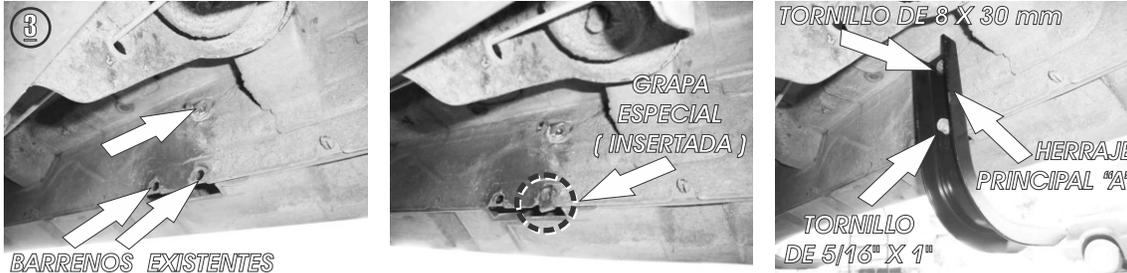
3.- Identifique los barrenos existentes por debajo de la carrocería del vehículo, en dirección del soporte medio e inserte UNA grapa especial en el Primer Barreno Inferior, fijando el **Herraje Principal "A"** en el barreno superior ( roscado ) con el tornillo de 8 X 30 mm y en la parte inferior fíjelo con la grapa que inserto utilizando el tornillo de 5/16" X 1" y las rondanas de 5/16".
