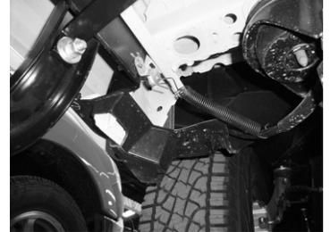
4.- Enseguida presente un extremo del Herraje Auxiliar "D" en el tornillo insertado y fíjelo con las rondanas y tuerca de 3/8".
