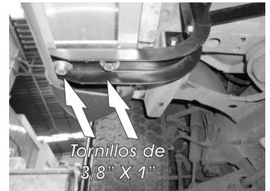
14.- Presente el estribo sobre los herrajes e introduzca los **Herrajes Auxiliares "F"** por dentro del estribo y deslicelos manualmente hasta que coincidan con los barrenos de los **Herrajes Principales**, enseguida fije los herrajes en manera de sandwich utilizando los tornillos de 3/8" X 1".
