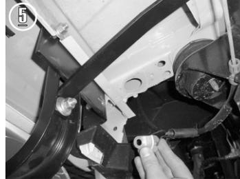
5.- Sujete ahora el resorte del chicote al Herraje instalado usando el tornillo de 1/4" X 1"
