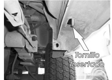
10.- Rosque la guía de micro-alambre con el Tornillo especial de 1/2" X 1 1/2" e inserte el tornillo en el barreno existente.
