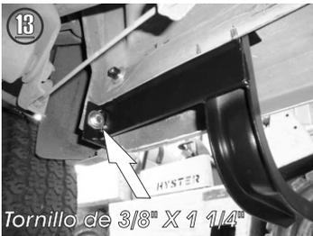
13.- De igual forma, fije el **Herraje** en el barreno posterior de la carrocería con un tornillo de 3/8" x 1 1/4".
