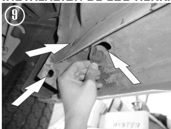
9.- Identifique los barrenos y resaque existentes por la parte posterior del del vehículo.
