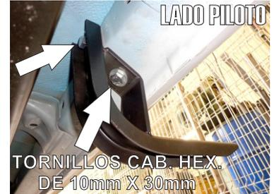
2.- De igual manera identifique los barrenos que están a un costado del Chasis marcados en la primer imagen y fije el **Herraje Intermedio "B"** a los mismos usando los Tornillos Cab. Hex. de 10mm X 30mm.
