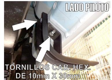
3.- De igual manera identifique los barrenos que están a un costado del Chasis marcados en la primer imagen y fije el **Herraje Posteriores "B"** a los mismos usando los Tornillos Cab. Hex. de 10mm X 30mm.
