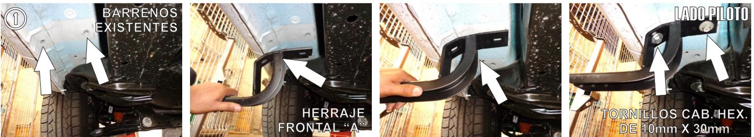
1.- Identifique los barrenos que están a un costado del Chasis marcados en la primer imagen y fije el Herraje Frontal "A" a los mismos usando los Tornillos Cab. Hex. de 10mm X 30mm.
