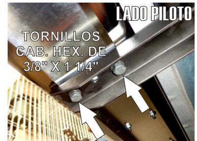
4.- Una vez que se han instalado los Herrajes anteriores presente el estribo del Lado Piloto e inserte el **Herraje Auxiliar "C"** por la parte posterior colocandolos en coincidencia de cada herraje y fijandolos con los Tornillos de 3/8" x 1 1/4" y Rondanas de 3/8".
