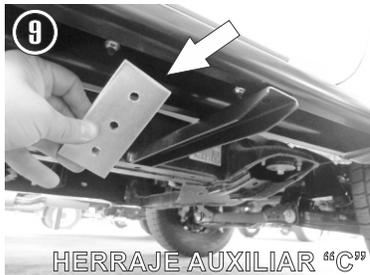
9.- Presente el estribo sobre los Herrajes e introduzca el **Herraje Auxiliar "C"** por dentro del estribo y deslicelo manualmente hasta que coincida con los barrenos de los **Herrajes Frontales "A" y Posteriores "B"**.
