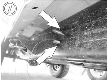
7.- Inserte otro herraje y otro tornillo en el segundo barreno, como en el paso anterior.
