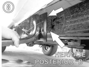
8.- Presente el **Herraje Posterior "B"** en la parte trasera del chasis e inserte las guías en los barrenos del Herraje sacando las puntas de los tornillos insertados. Retire las guías; una por una y fije el herraje con las rondanas y tuercas de 1/2".
