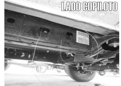
2.- De igual forma introduzca otro Tornillo Cab. de Coche de 1/2" X 1 1/2" junto con una Solera Cuadrada en el orificio posterior ayudándose con la Guía de Micro-Alambre.
