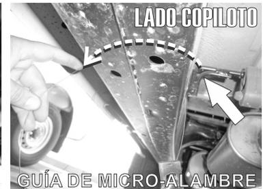
4.- Identifique los barrenos posteriores del Chasis con forme se muestra en las fotografías anexas.
