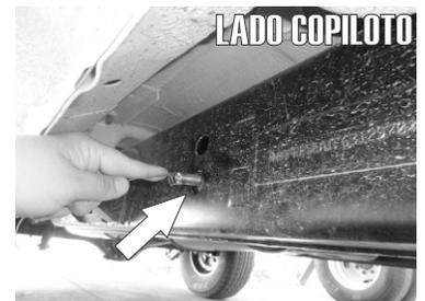
6.- Inserte manualmente la Solera Cuadrada dentro del barreno y enseguida el tornillo, jalando al mismo tiempo la guía por el otro extremo hasta que salga la punta del Tornillo Cab. Coche por el barreno frontal.
