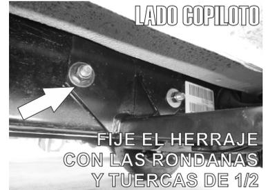
3.- Inserte el Herraje Frontal "A" a mitad del chasis y deslicelo hasta los barrenos frontales del chasis insertando las Guías de Micro-Alambre en los barrenos del Herraje para poder sacar los tornillos y fijar con las Rondanas y Tuercas de 1/2".
