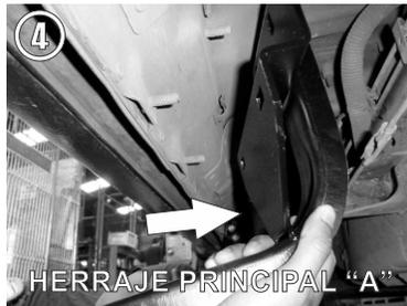
4.- Presente el **Herraje Principal "A"** insertando los tornillos en los barrenos y fije con las Tuercas de 8mm y Rondanas de 5/16".
