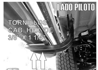
7.- Una vez que se han instalado los Herrajes anteriores presente el estribo del Lado Piloto e inserte el **Herraje Auxiliar "B"** por la parte posterior colocandolos en coincidencia de cada herraje y fijandolos con los Tornillos de 3/8" x 1 1/4" y Rondanas de 3/8" a modo de Sandwich.
