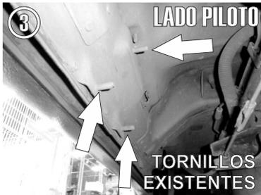
3.- Identifique los tornillos de bajo del vehículo al costado del chasis.
