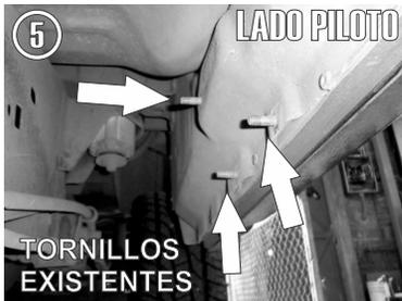
5.- Identifique los tornillos de bajo del vehículo al costado del chasis.
