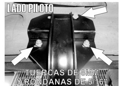
1.- Identifique los tornillos de bajo del vehículo al costado del chasis.
