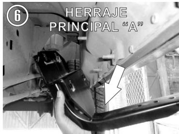
6.- Presente el **Herraje Principal "A"** insertando los tornillos en los barrenos y fije con las Tuercas de 8mm y Rondanas de 5/16".
