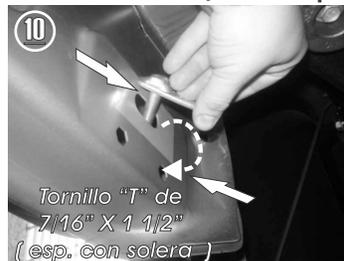
10.- Inserte en manera de giro los tornillos "T" de 7/16" X 1 1/2" ( con solera soldada ) dentro de los barrenos de la carrocería, tanto de la parte lateral como en la parte superior.
