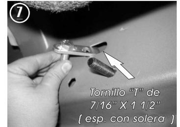
7.- Inserte el tornillo "T" de 7/16" X 1 1/2" ( con solera soldada ) dentro del barreno de la carrocería.
