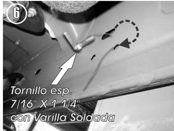
6.- Rosque la guía de micro-alambre con el tornillo especial de 7/16" X 1 1/4" con varilla soldada, e inserte el tornillo del barreno superior hacia el barreno inferior. Una vez insertado, desenrosque la guía de micro-alambre.
