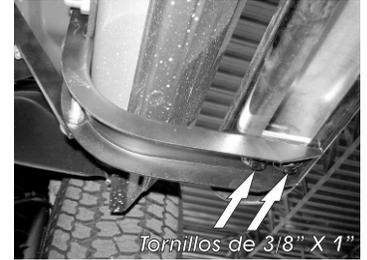
13.- Presente el estribo sobre los herrajes e introduzca el Herraje Auxiliar "D" por dentro del estribo y deslicelo manualmente hasta que coincida con los barrenos de los Herrajes Principales "A" y "B", enseguida fije los herrajes en manera de sandwich utilizando los tornillos de 3/8" X 1".
