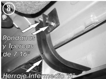
8.- Enseguida fije el **Herraje Intermedio "A"** en los tornillos que inserto con las rondanas y tuercas de 7/16"
