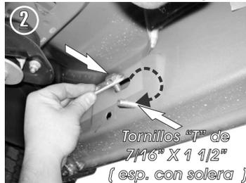
2.- Inserte en manera de giro los tornillos "T" de 7/16" X 1 1/2" ( con solera soldada ) dentro de los barrenos de la carrocería, tanto de la parte lateral como en la parte superior.
