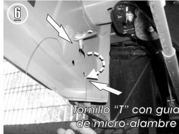
6.- Rosque la guía de micro-alambre con el tornillo "T" especial e inserte el tornillo del resaque superior hacia el barreno inferior.
