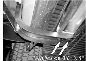
9.- Presente el estribo sobre los herrajes e introduzca el **Herraje Auxiliar "D"** por dentro del estribo y deslicelo manualmente hasta que coincida con los barrenos de los **Herrajes Principales "A" y "B"**, enseguida fije los herrajes en manera de sandwich utilizando los tornillos de 3/8" X 1".
