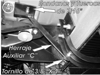
4.- Presente el **Herraje Auxiliar "C"** en el tornillo superior que inserto y fijelo con las rondanas y tuercas de 7/16" y al otro extremo fijelo en el barreno del **Herraje Frontal "A"** con el tornillo de 3/8" X 1".
