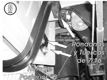
8.- Enseguida presente el **Herraje Posterior "B"** en los tornillos que inserto y fijelo con las rondanas y tuercas de 7/16"
