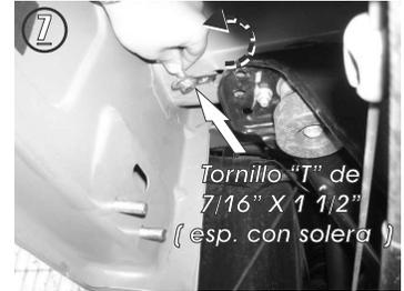
7.- Desenrosque la guía de micro-alambre e inserte en manera de giro, otro tornillo "T" especial en el barreno superior de la carrocería.
