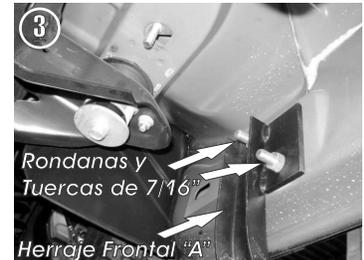
3.- Enseguida fije el Herraje Frontal "A" en los tornillos laterales que inserto con las rondanas y tuercas de 7/16"
