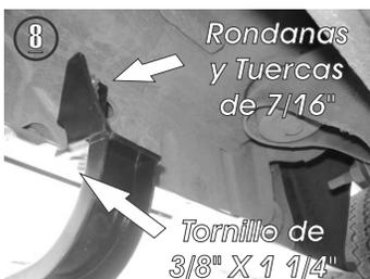
8.- Presente el **Herraje Principal "A"** en el tornillo superior y fijelo con las rondanas y tuerca de 7/16". Enseguida fije el herraje con el barreno inferior de la carrocería utilizando el tornillo de 3/8" X 1 1/4".
