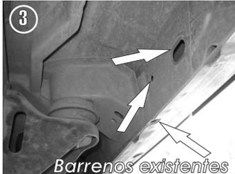
3.- Identifique los dos barrenos cerca del soporte intermedio de la carrocería y en caso de traer tapones de plástico, proceda a retirarlos manualmente.
