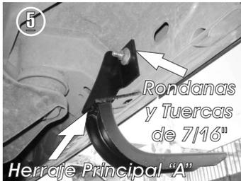
5.- Presente el **Herraje Principal "A"** en el tornillo que inserto y fijelo con las rondanas y tuercas 7/16". Después fije el herraje con el barreno inferior de la carrocería utilizando el tornillo de 3/8" X 1 1/4".
