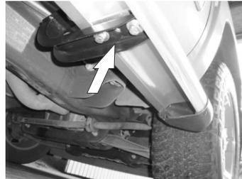
10.- Nivele y centre el estribo y apriete hasta el final todos los tornillos empezando por los herrajes para lograr una correcta instalación.
