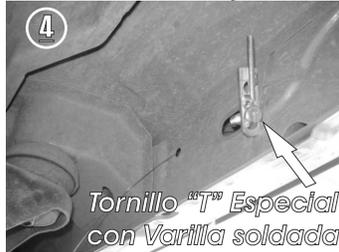
4.- Rosque la guía de micro-alambre con el tornillo "T" e inserte la guía del barreno grande hacia el barreno pequeño.
