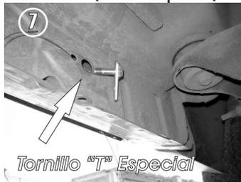
7.- Rosque la guía de micro-alambre con el tornillo "T" e inserte el tornillo manualmente en el barreno grande. Enseguida meta la punta de la guía del barreno grande hacia el pequeño y jale la guía hasta sacar la punta del tornillo. Una vez insertado el tornillo, desenrosque la guía cuidadosamente, evitando que el tornillo caiga dentro de la carrocería ó si prefiere coloque el **Herraje Principal "A"** y desenrosque la guía de micro-alambre.
