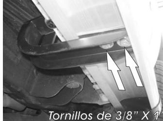
9.-Presente el estribo sobre los Herrajes Principales e introduzca los **Herrajes Auxiliares "B"** por dentro del estribo y deslicelos manualmente hasta que coincidan con los barrenos de los **Herrajes Principales "A"**. Enseguida fije el estribo en manera de sandwich utilizando los tornillos de 3/8" X 1".
