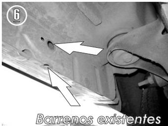
6.- Identifique los dos barrenos en la parte posterior de la carrocería y en caso de traer tapones de plástico proceda a retirarlos manualmente.
