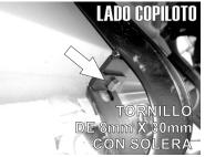
5.- Identifique las grapas existentes señaladas en la parte intermedia trasera del vehiculo y proceda a retirarlas para descubrir ambos barrenos roscados.
