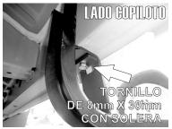
3.- Identifique las grapas existentes señaladas en la parte intermedia frontal del vehiculo y proceda a retirarlas para descubrir ambos barrenos roscados.
