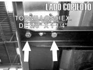
9.- Presente el estribo sobre los Herrajes Principales e introduzca los Herrajes Auxiliares "B" por dentro del estribo y deslicelos manualmente hasta que coincidan con los barrenos de los Herrajes Principales "A", enseguida fije los herrajes en manera de sandwich utilizando los tornillos de 3/8" X 1 1/4".
