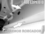
1.- Identifique las grapas existentes señaladas en la parte frontal del vehiculo y proceda a retirarlas para descubrir ambos barrenos roscados.
