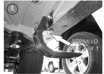
3.- Enseguida presente el **Herraje Principal "A"** en la carrocería y fíjelo en la parte superior con la grapa que inserto utilizando las rondanas de 5/16" y el tornillo de 5/16" X 1".
