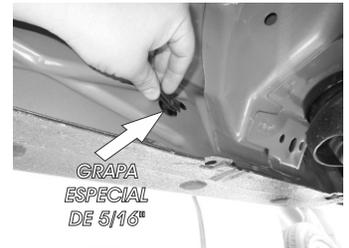
5.- Identifique los barrenos existentes por debajo de la carrocería del vehículo y retire con un desarmador plano los tapones de plástico.
