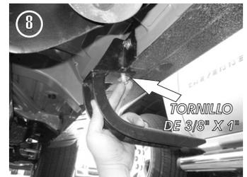
7.- Enseguida presente el **Herraje Principal "A"** en la carrocería y fíjelo en la parte superior con la grapa que inserto utilizando las rondanas de 5/16" y el tornillo de 5/16" X 1".
