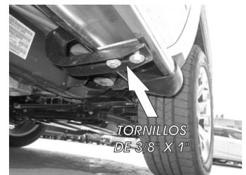
9.- Presente el estribo sobre los herrajes principales e introduzca los **Herrajes Auxiliares "B"** por dentro del estribo y deslicelos manualmente hasta que coincidan con los barrenos de los **Herrajes Principales "A"**, enseguida fije los herrajes en manera de sandwich utilizando los tornillos de 3/8" X 1".
