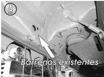
4.- Identifique los dos barrenos en la parte posterior de la carrocería y en caso de traer tapones de plástico, proceda a retirarlos manualmente.
