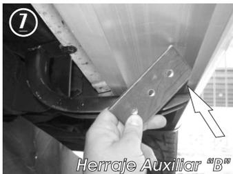
7.- Presente el estribo sobre los Herrajes Principales e introduzca los **Herrajes Auxiliares "B"** por dentro del estribo y deslicelos manualmente hasta que coincidan con los barrenos de los **Herrajes Principales "A"**. Enseguida fije el estribo en manera de sandwich utilizando los tornillos de 3/8" X 1".
