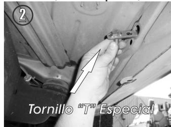
2.- Rosque la guía de micro-alambre con el tornillo "T" e inserte el Tornillo manualmente en el barreno grande. Enseguida meta la punta de la guía del barreno grande hacia el pequeño y jale la guía hasta sacar la punta del tornillo por dicho barreno. Una vez insertado el tornillo, desenrosque la guía cuidadosamente, evitando que el tornillo caiga dentro de la carrocería ó si prefiere coloque el Herraje Principal "A" y con el mismo, trabe el tornillo y desenrosque la guía de micro-alambre.
