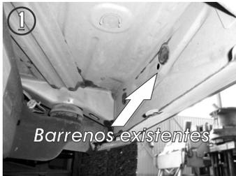
1.- Identifique los dos barrenos en la parte frontal de la carrocería y en caso de traer tapones de plástico, proceda a retirarlos manualmente.
