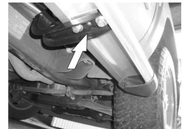
8.- Nivele y centre el estribo y apriete hasta el final todos los tornillos empezando por los herrajes para lograr una correcta instalación. En algunas versiones de Pick-ups tendrá que hacer presión manual sobre los Herrajes Principales y reapretar los tornillos con la carrocería; para lograr una correcta nivelación del estribo.
