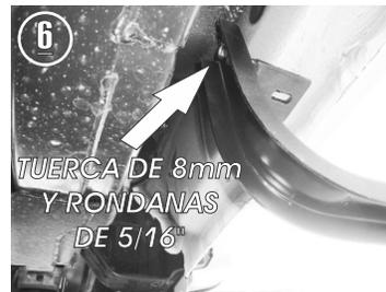
6.- Presente el **Herraje Principal "A"** en el tornillo superior y fíjelo con la tuerca de 8mm y las rondanas de 5/16" y en la parte inferior fije el Herraje con el tornillo de 8 X 30mm y las rondanas de 5/16".
