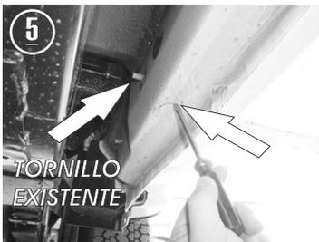
5.- Identifique el tornillo existente por debajo de la carrocería del vehículo, ( en dirección de la manija de la puerta posterior ) y descubra la tuerca existente, quitando la cinta plástica en la parte inferior de la carrocería, ayudado con un desarmador plano.
