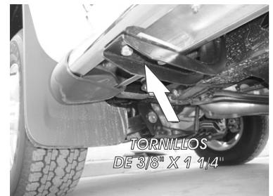
5.- Presente el estribo sobre los herrajes principales e introduzca los **Herrajes Auxiliares "B"** por dentro del estribo y deslícelos manualmente hasta que coincidan con los barrenos de los **Herrajes Principales "A"**, enseguida fije los herrajes en manera de sandwich utilizando los tornillos de 3/8" X 1 1/4".
