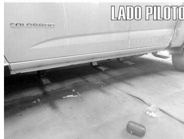
4.- Una vez más inserte un par de Grapas de 5/16" en los Barrenos señalados y fijando los Herrajes Posteriores "C" con sus respectivos Tornillos y Rondanas de 5/16".
