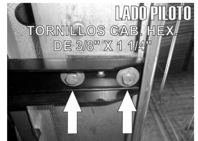
5.- Presente el estribo sobre los Herrajes Principales e introduzca los Herrajes Auxiliares "D" por dentro del estribo y deslicelos manualmente hasta que coincidan con los barrenos de los Herrajes Principales "A". Enseguida fije el estribo en manera de sandwich utilizando los tornillos de 3/8" X 1 1/4".
