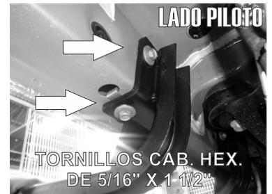
3.- De igual forma inserte un par de Grapas de 5/16" en los Barrenos señalados y fijando los Herrajes Intermedios "B" con sus respectivos Tornillos y Rondanas de 5/16".
