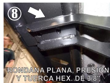
8.- Coloque los Tornillos Cab. Hexagonal de 3/8" x 1 1/4, y rondana plana como se muestra en la imagen, y por el otro extremo del tornillo, coloque Rondana Plana, de Presión y Tuerca Hexagonal de 3/8".
