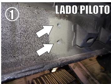
1.- Una vez retirados los estribos de agencia (Lado Piloto/Copiloto), podrá observar los barrenos roscados existentes en el chasis del vehículo. Estos barrenos serán utilizados para fijar de manera segura el nuevo herraje de los estribos modelo 4XR.
