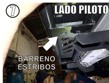
7.- Posicione y ubique los barrenos de los herrajes con los del estribo.
