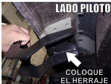
3.- Posicione el Herraje Principal "A" sobre los barrenos existentes y coloque los Tornillos Cabeza Hexagonal de 8mm X 30 mm, Rondana Plana y de Presión de 5/16" y repita el mismo procedimiento en el Herraje Medio y Posterior del vehículo. Lado Piloto y Copiloto.
