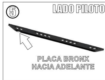
5.- Al colocar el estribo (4XR), correctamente debe guiarse por la placa de la marca (BronX) el cual le indica que va hacia el frente del vehículo y eso aplica tanto lado Piloto/Copiloto.
