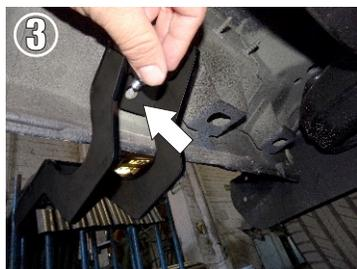
3.- Una vez que coloco los Tornillos en los 2 barrenos de cada Herraje, no fije en su totalidad la Tornillería hasta no colocar el Perfil (estribo 4XR).
