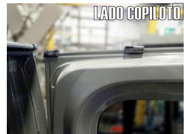
1.- Arme el Herraje Principal "A" con el Herraje Auxiliar "B" utilizando los Tornillos Cab. Botón Allén de 5/16" X 2 1/2" y a su vez el Herraje Principal "A" con el cuerpo central de la escalera, utilizando los Tornillos Cab. Botón Allén de 5/16" X 2". Enseguida posicione la Escalera en la Puerta posterior como se muestra en las imágenes. Escalera, enganchela al porta equipaje del lado Copiloto.
