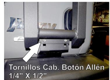
2.- Coloque el Herraje Auxiliar "C" por la parte inferior de la escalera y verifique que coincidan los barrenos de la escalera y del mismo modo enganche con la parte inferior de la puerta y comience a fijarlo con los Tornillo Cab. Botón Allén 1/4" x 1/2" , estos le darán el ajuste necesario para fijarlo a la puerta.
