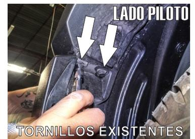
1.- Identifique los tornillos y grapas que sujetan la defensa plástica delantera de la carrocería y proceda a retirarla. Igualmente retire las grapas y tornillos señalados en las imágenes, que la sujetan por la parte frontal del salpicadero.
