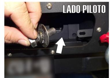
10.- Coloque la facia nuevamente y fijela con las grapas y tornillos que retiro con anterioridad. No olvide conectar los arneses.
