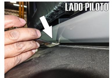
2.- Abra el cofre del vehículo y retire las grapas que sujetan la defensa en el travesaño frontal, use un destornillador o sacagrapas si es necesario.
