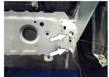
5.- Inserte la Solera Redondeada en la Guía de Micro-Alambre 5/16" y después rosque el Tornillo Esp.Hex. c/Varilla de 5/16" X 1" sobre la misma Guía. Una vez que tiene ambas piezas, introduzca el tornillo y la solera sobre uno de los barrenos existentes. ya que tiene colocado ambas piezas en el interior jale poco a poco la guía hasta que salga la punta del tornillo por el barreno. Repita el mismo procedimiento con otro tornillo y solera en el barreno inferior
