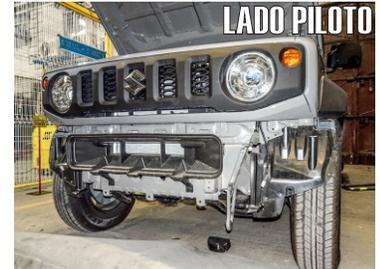
3.- Una vez retirados todas las grapas y tornillos que la sujetan, retire la defensa jalando con cuidado y safando los contactos de los cables que estén de la misma.
