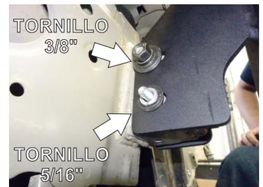
6.- Inserte las guías sobre los barrenos del Herraje Principal "A" y jale las guías hasta sacar a la punta de los tornillos. Retire con precaución las guía de micro alambre evitando que los tornillos caigan dentro del puente y fije el herraje con las Rondanas Planas, de presión y Tuercas Hex. de 5/16".
