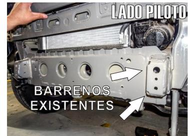
4.- Ahora deberá retirar la toma de aire plástica frontal del chasis retirando las grapas que la sujetan, (tal como se observa en las fotos) Después de retirarlo ubique los barrenos existentes del puente frontal.
