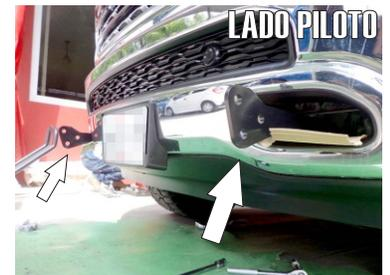
4.- Posicione y fije el **Herraje Auxiliar "C"** en el barreno lateral existente en el **Herraje Principal "A"**, quedando alineado al barreno superior del travesaño interno del vehículo, tal como se observa.
