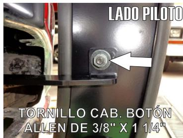
9.- Finalmente presente la burrera por fuera de los herrajes fijandola a los **Herrajes Principales "A"** con los tornillos de 1/2" X 1 1/2" y en la parte superior fije a los **Herrajes Auxiliares "B"** con los tornillos cab. botón allén de 3/8" X 1 1/4".
