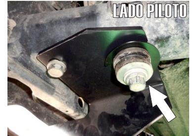
2.- Presente el **Herraje Principal "A"** y posícelo en el lugar del gancho. Fíjelo con el tornillo existente retirado en el paso anterior e introduzca **La Calza calibre 11** a modo de rondana en el otro tornillo para apretarlo de igual forma.
