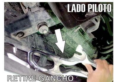
1.- Identifique los ganchos existentes en la parte inferior frontal del chasis. Retire el tornillo seleccionado y afloje en segundo. Safe el gancho hacia atrás y retirelo de su lugar.
