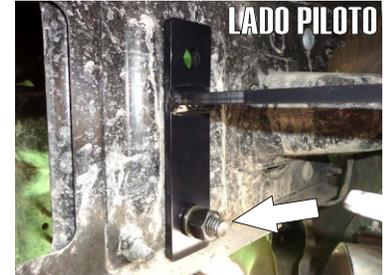
6.- Inserte el **Herraje Auxiliar "B"** y alínelo a los barrenos del travesaño interno. Inserte por detrás un tornillo Hex. de 1/2" X 1 1/2", fijando de igual forma el **Herraje Auxiliar "C"** del otro lado.
