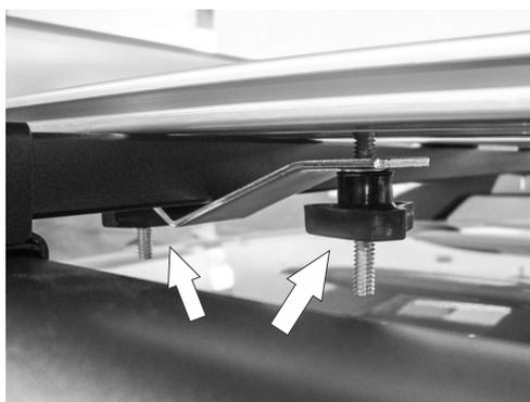
3.- Por la parte inferior, a modo de sandwich, fije el **Herraje en "V"** y con dos perillas, rondanas y tuercas de 1/4", apriete los Herrajes firmemente y de manera igual para ambos tornillos.
