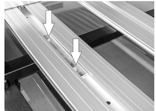
1.- Presente la Canastilla por sobre las barras existentes en el vehículo alineando estas en dos de los barrenos existentes en las canaletas laterales de la canastilla. Inserte por la parte superior el **Herraje Plano** alineado a los barrenos sobre la barra transversal tal como se observa.
