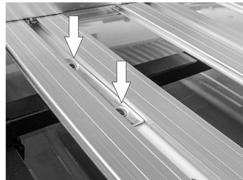
2.- Inserte dos tornillos cabeza de coche de 1/4" X 2" en los barrenos del **Herraje Plano** puesto anteriormente, pasando por cada lado de la barra del vehículo por la parte de abajo.
