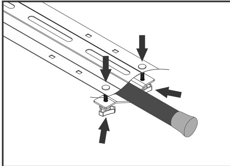
2.- Inserte dos tornillos cabeza de coche de 1/4" X 2" en los barrenos de la Canaleta de la canastilla, pasando por cada lado de la barra del vehículo por la parte de abajo. Por la parte inferior, a modo de sandwich, fije el **Herraje en "V"** y con dos perillas, rondanas y tuercas de 1/4", apriete los Herrajes firmemente y de manera igual para ambos tornillos.
