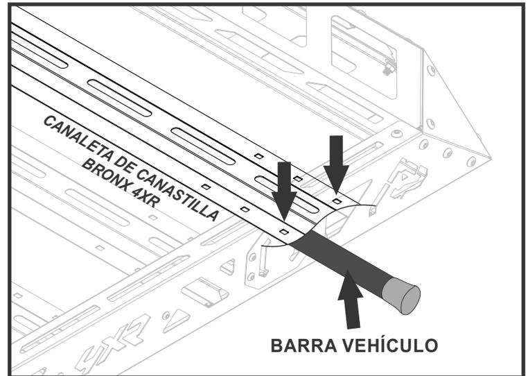
1.- Presente la Canastilla por sobre las barras existentes en el vehículo alineando estas en dos de los barrenos existentes en las canaletas de la misma tal como se muestra.
