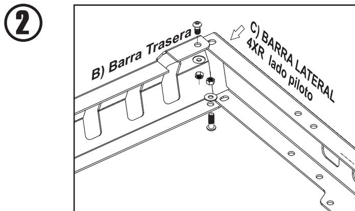
2.- Ensamble la **Barra Trasera** con las **Barras Laterales Piloto y Copiloto**, colocando las pestañas superior e inferior por dentro de la barra trasera.
