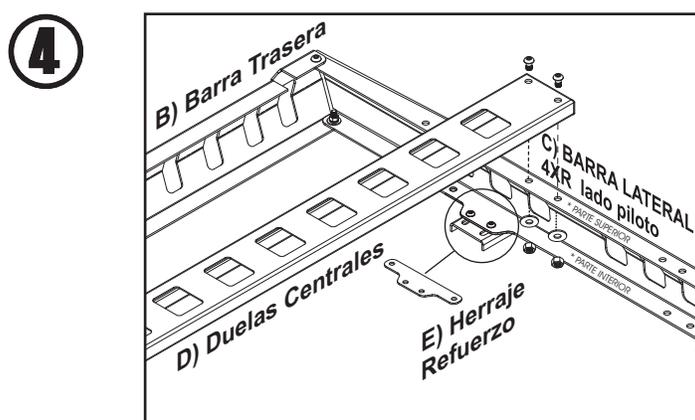
4.- En caso de colocarlas en la parte superior para modo camping, fije las duelas con los **Tornillos Cab. Botón Allén 5/16" X 3/4" inoxidable, Rondana Plana y las Tuercas Hex. Seguridad de . 5/16"**.
