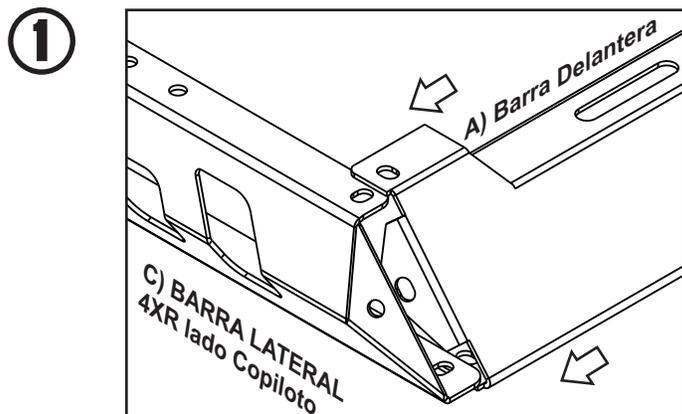
1.- Ensamble la **Barra Delantera** con las **Barras Laterales Piloto y Copiloto**, posicione las pestañas superior e inferior, por el interior de la Barra Delantera y verifique que la pestaña de la Barra Delantera quede por el interior.
