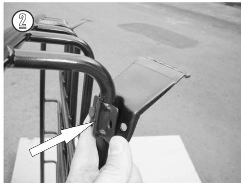
2.- Coloque los ganchos en los tubos exteriores y fíjelos manualmente como se muestra en la fotografía, utilizando los tornillos de 1/4" X 3/4" y las rondanas y tuercas de 1/4".
