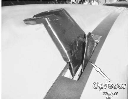
5.-Enseguida inserte por dentro de la pestaña el opresor "B" de forma que las uñas del herraje se atoren en la pestaña del botaguas.
