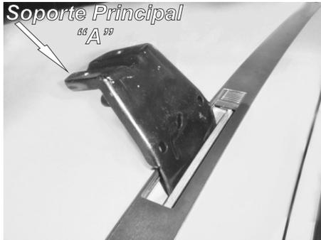
4.-Coloque el Soporte Principal "A" por fuera de la pestaña metálica.
