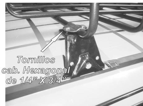
9.-Coloque El Herraje Superior sobre el barrote de la canastilla y fijela con los tornillos cab. hexagonal de 1/4" X 3/4" como lo indica la fotografía.
