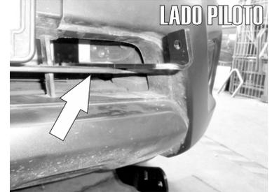
9.- Arme el Herraje Auxiliar "B" junto con el Herraje Auxiliar "C" y un Tornillo Cab. Hex. de 3/8" X 2 1/2" como se muestra en la primer imagen y colóquelo en el puente transversal que está entre el Radiador y la Parrilla de la defensa sacándolo por la primer rendija superior.
