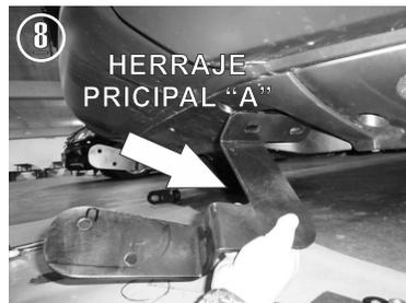
8.- Una vez insertados los Tornillos Especiales "T" instale el **Herraje Pricipal "A"** (Lado Piloto) y sujételo a los tornillos con las tuercas y rondanas de 7/16"
