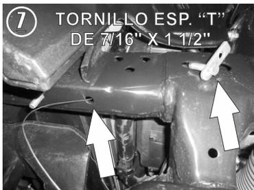
7.- Introduzca de igual forma otro Tornillo Especial "T" en el segundo barreno inferior del chasis con la guía de Micro-Alambre.
