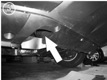
5.- Ahora instale el **Herraje Principal "A"** (Lado Copiloto) en el lugar donde iba el gancho de arrastre usando los tornillos existentes retirados anteriormente para fijarlo.
