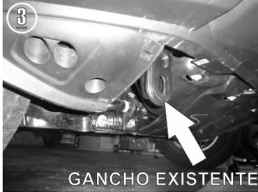
3.- Una vez retirada la tolva ubique el gancho de arrastre y retirelo quitando los dos Tornillos existentes que lo sujetan al chasis.
