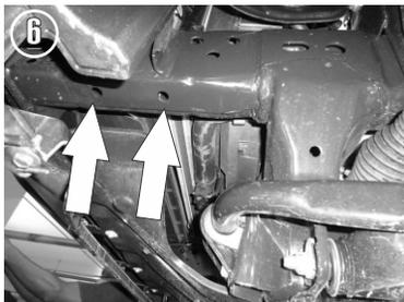
6.- Para instalar el Herraje del lado Piloto deberá insertar el Tornillo Especial "T" de 7/16" X 1 1/2" con ayuda de la Guia de Micro-Alambre pasando desde el barreno lateral del chasis al inferior tal como se ilustra en las fotos.
