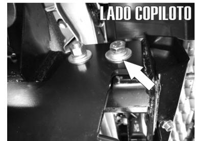
4.- Una vez fijado el Herraje inserte el Tornillo de 10mm X 30mm en el barreno roscado aledaño.
