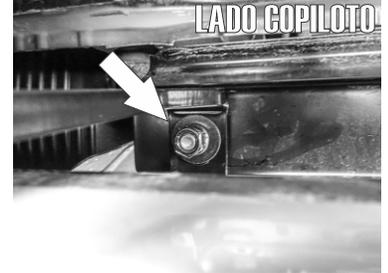
7.- Por la rendija inferior de la Parrilla frontal introduzca el Herraje Auxiliar "B" y fíjelo al Tornillo Previamente insertado con la Guía de Micro-Alambre.
