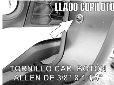
8.- Una vez instalados los Herrajes de ambos lados presente e instale la Burrera Super Bronco a los Herrajes usando los Tornillos de 1/2" X 1 1/2" para el Herraje Principal y el Tornillo Cabeza Botón Allen de 3/8" X 1 1/4".
