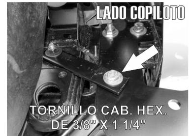
5.- Use el Herraje Auxiliar "C" (Lado Copiloto) para reforzar el Herraje principal "A" fijandolo al gancho de arrastre, esta vez con un Tornillo Esp. con varilla soldada de 3/8" X 1 1/4" insertandolo por la parte interna del gancho tal como se observa y con un Tornillo Cab. Hex. de 3/8" X 1 1/4" al Herraje. (El Galuz va hacia el Herraje Principal).
