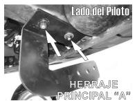
**5.-**Identifique los barrenos y resaques existentes por debajo del chasis. Rosque un tornillo especial de 7/16" X 1 1/2" con la guía de micro-alambre e insertelo del resaque cuadrado hacia el segundo barreno del chasis.
