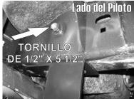
7.- Levante el cofre y ubique los tornillos superiores que fijan la placa del chasis con la defensa y proceda a retirar la tuerca con la llave 21 mm. Enseguida presente el **Herraje Auxiliar "B"** en dicho tornillo y fijelo con la tuerca que retiro con anterioridad. El otro extremo del Herraje fijelo con el barreno del chasis utilizando el tornillo de 1/2" X 5 1/2".
