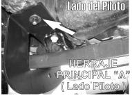
**3.-** Identifique los barrenos y resaques existentes por debajo del chasis y coloque un tornillo especial de 7/16" X 1 1/2" dentro del chasis, en el resaque que muestra la fotografía.
