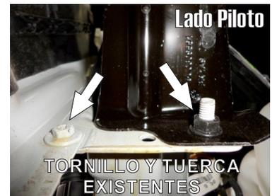
1.- Identifique la tolva inferior delantera del vehículo y retire el tornillo lateral marcado en la primer imagen para poder jalar hacia abajo la tolva posterior.
