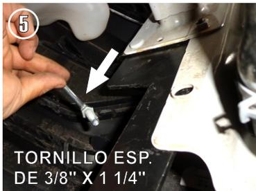
5.- Inserte un Tornillo Especial de 3/8" X 1 1/4" con Varilla en el barreno medio del Herraje Principal "A" y la lámina del vehículo.
