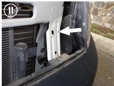
13.- De lado Copiloto deberá insertar de igual manera un Tornillo Hex. de 1/4" X 1" entre el radiador y la lámina.
