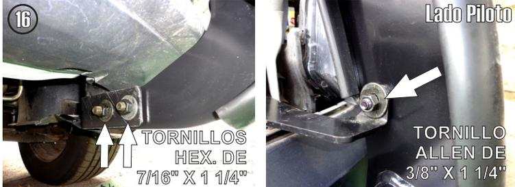
16.- Finalmente puestos los Herrajes monte la Burrera a estos usando los Tornillos Hex. de 7/16" X 1 1/4" para la parte inferior y los Tornillos Cab. Botón Allen de 3/8" X 1 1/4" para los herrajes superiores.
