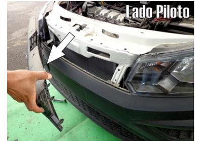
12.- Presente el Herraje Auxiliar "C" (Lado Piloto) y fíjelo al travesaño con el tornillo insertado.
