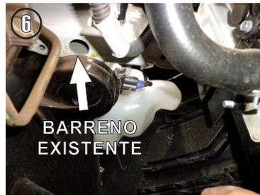
6.- Identifique el barreno existente por la parte inferior del chasis e introduzca un Tornillo Especial de 7/16" X 1 1/2" con Solera tal como se muestra.
