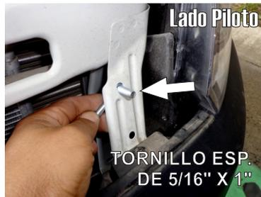
14.- Igualmente presente el Herraje Auxiliar "C" (Lado Copiloto) y fíjelo al travesaño con el tornillo insertado.
