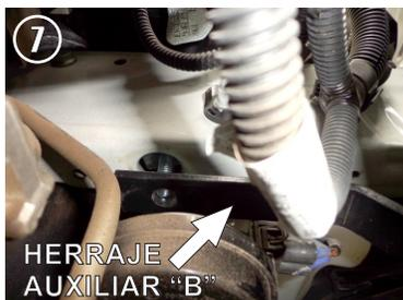
7.- Una vez puestos los Tornillos Especiales monte el Herraje Auxiliar "B" cuidando que el dobles más largo quede por la parte superior. Asegurese de fijarlo con sus respectivas rondanas, 7/16" para la parte superior y 3/8" para el lateral.
