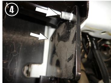
4.- Fijelo al chasis usando la tuerca existente y un Tornillo Hex de 6mm X 25mm.
