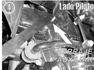
4.- Coloque el Herraje Auxiliar "B" en dicho tornillo y retire la guía de micro-alambre fijando el herraje con las rondanas y tuerca de 7/16".
