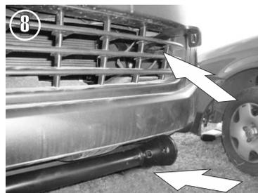
8.- Presente la burrera por fuera del Herraje Principal "A" y fijela con los tornillos de 1/2" X 1 1/2" y en la parte superior fije el Herraje Auxiliar "C" por dentro de la burrera con el tornillo cab. botón allén de 3/8" X 1 1/4".
