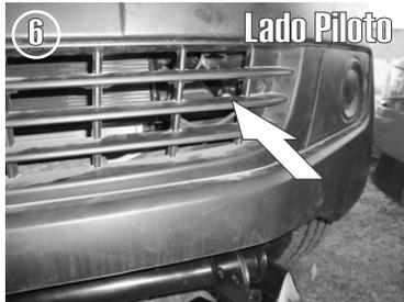
6.- Después identifique el soporte que fija la defensa con la carrocería y proceda a retirar el tornillo existente por dentro de la defensa con la llave de 1/2".
