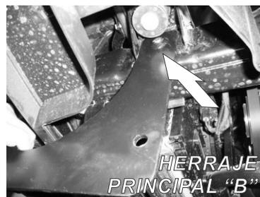
1.- Identifique el barreno existente por debajo del soporte del chasis e inserte un tornillo de 1/2" X 4" de adentro hacia fuera, utilizando una solera cuadrada como rondana.
