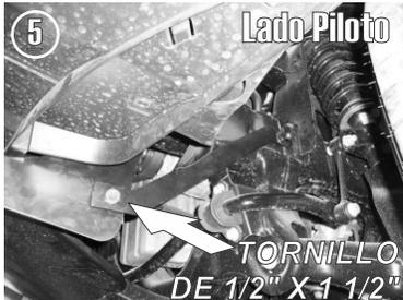
5.- Enseguida fije el Herraje Auxiliar "B" con el Herraje Principal "A" utilizando el tornillo de 1/2" X 1 1/2".
