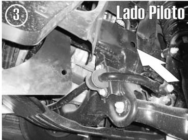
3.- Identifique el barreno posterior sobre el chasis en dirección del resorte de suspensión y rosque la guía de micro-alambre con un tornillo especial de 7/16" X 1 1/2" e insertelo en dicho barreno.
