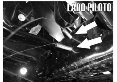
6.- Introduzca otro Tornillo Esp. con varilla de 5/16" con ayuda de la guía de micro-alambre, pasando del barreno mas grande (galuz) hacia el barreno posterior dejando la rosca hacia fuera.
