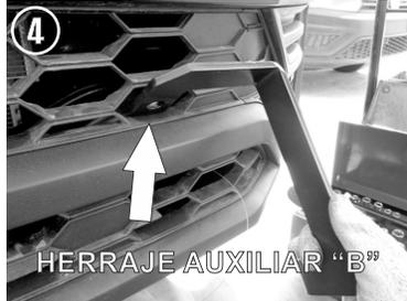
4.- Inserte el Herraje Auxiliar "B" por la rendija de la parrilla superior marcada en la imagen y fijelo al tornillo previamente insertado usando las rondanas y tuerca de 7/2"
