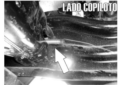
10.- De lado Copiloto igualmente deberá insertar en el barreno ( Galuz ), con ayuda de una guía, un tornillo esp. con varilla de 7/16" junto con una solera para tornillo, metiendo primero el tornillo y enseguida la solera, después jale el tornillo sacando la rosca hacia afuera del barreno, tal como se señala.
