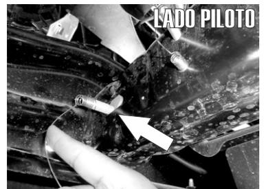
7.- Con ayuda de otra guía de micro-alambre inserte un tornillo esp. con varilla de 7/16" junto con una solera para tornillo, metiendo primero el tornillo y enseguida la solera, después jale el tornillo sacando la rosca hacia afuera del barreno, tal como se señala.
