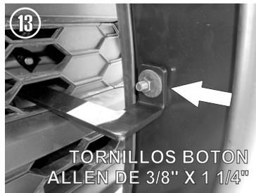
13.- Finalmente monte la Burrera e instalela sobre la parte externa de los Herrajes, usando los tornillos boton allen de 3/8" X 1 1/4" para los auxiliares y los tornillos hexagonales de 1/2" X 1 1/2" para los principales.
