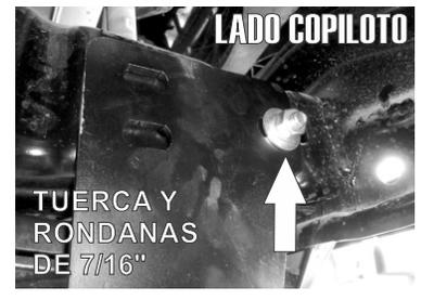
11.- Presente el **Herraje Principal "A"** (**Lado Copiloto**) pasando la guía por el primer barreno señalado e inserte en el tornillo sobre el chasis. Fíjelo con la tuerca y las rondanas de 7/16".
