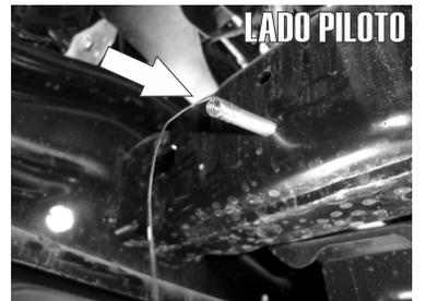
5.- Identifique, en la parte frontal inferior del auto, los barrenos existentes laterales en el chasis señalado en las imágenes superiores y proceda a insertar un Tornillo Esp. con varilla de 5/16" con ayuda de la guía de micro-alambre, pasando del barreno mas grande (galuz) hacia el barreno posterior dejando la rosca hacia fuera tal como se observa.
