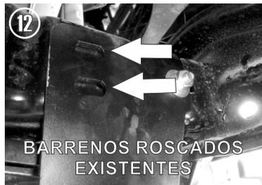
12.- Termine de fija el herraje usando dos tornillos de 8mm X 30mm en los barrenos roscados posteriores.
