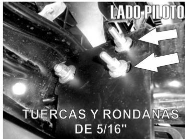
9.- Retire con cuidado las guías procurando que ningún tornillo se caiga y use las tuercas y rondanas de 5/16" y 7/16" respectivamente para fijar el Herraje.
