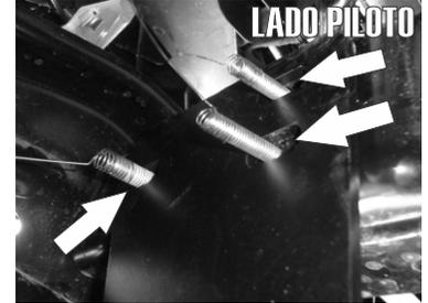
8.- Una vez puestos los tornillos presente el **Herraje Principal "A"** y pase las guías de estos por los barrenos del herraje. finalmente alinee y fíjelo en los tornillos.
