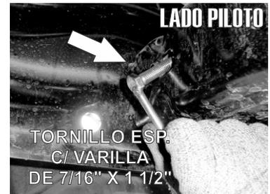
1.- Por la parte frontal de la defensa, ubique en la parrilla inferior, el barreno lateral que se muestra en la primer imagen y proceda a introducir una guía de micro-alambre para después sacarlo por la parte interna, a un constado del chasis. Tal como se observa.
