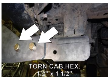
20.- Presente la Burrera y verifique que los barrenos de los Herrajes Principales "A", coincidan con los barrenos de la Burrera , como también los barrenos que se encuentra en el canal donde fijara los Auxiliares "D".
