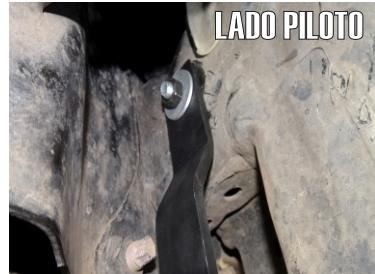
**6.- NOTA: NO RETIRE LA GUÍA DEL TORNILLO ESPECIAL. YA QUE LE AYUDARA A FIJAR EL AUXILIAR "B".**
