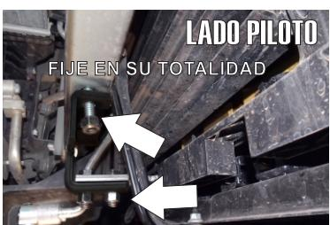
19.- Una vez que introduce el Herraje Auxiliar "D", posicionelo arriba de los barrenos del herraje auxiliar "C".
