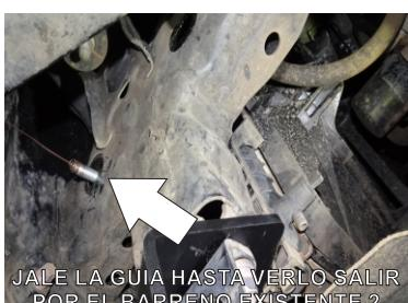
6.- Una vez que salio la Guía por el Barreno Existente 1, proceda a insertar sobre uno de los barrenos de la solera la Guía, enseguida enrosque el **Tornillo Esp. Hex. c/Varilla de 3/8" x 1 1/2"**, sobre la guía como se muestra en la imagen y después introduzca sobre el Barreno Existente 1 la solera y el tornillo, hasta hacerlo llegar al Barreno Existente 2.
