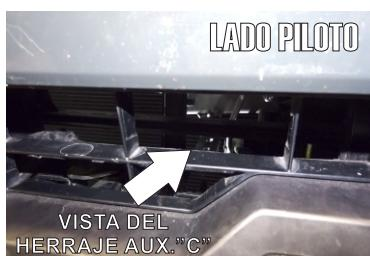
16.- Posicione el Herraje Aux. "C" Dirija el barreno del herraje al Torn.Esp.Hex.c/varilla. de 7/16" que previamente coloco.
