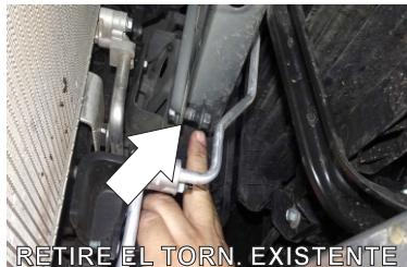
12.- Ubique sobre el frente del vehículo, las ranuras por donde respira el radiador Lado Piloto y Copiloto, y se puede observar unos tornillos existentes que le ayudara a colocar el Auxiliar "D".
