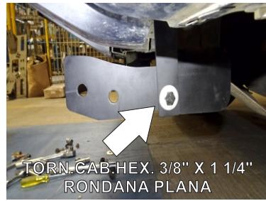
**12.- Una vez puestos ambos Herrajes "A" y "B", proceda a verificar que coincidan los barrenos señalados en la imagen y proceda a colocar el Tornillo Cab.Hex. de 3/8" x 1 1/4", con sus respectivas Rondanas Planas, de Presión y Tuerca Hexagonal de 3/8".**
