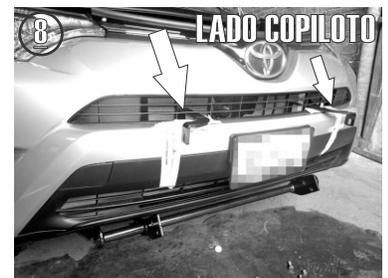
7.- Introduzca el **Herraje Auxiliar "C"** por la parrilla frontal del vehículo en la segunda rendija horizontal y la segunda hacia abajo y fíjelo al **Herraje Auxiliar "B"** previamente instalado, use el Tornillo Cab. Hex. de 3/8" X 1 1/4"
