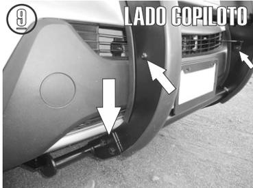
9.- Finalmente presente he instale la **Burrera Super Bronco** a los herrajes por la parte interior del Herraje Principal "A" con los Tornillos Cab. Hex. de 1/2" X 1 1/2" y sujetelo al Herraje Auxiliar "C" con los Tornillos Cab. Botón Allen de 3/8" X 1 1/4"
