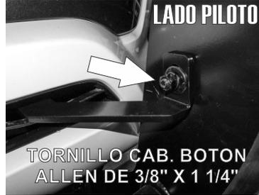
8.- Ya puestos los Herrajes Piloto y Copiloto de igual forma, proceda a instalar la Burrera Super Bronco sujetandola con los Tornillos de 1/2" X 1 1/2" para la parte inferior ( Herrajes Principales ) y con los Tornillos Cab. Boton Allen de 3/8" X 1 1/4" para la parte superior (Herrajes Auxiliares ) con sus respectivas Rondanas y Tuercas.
