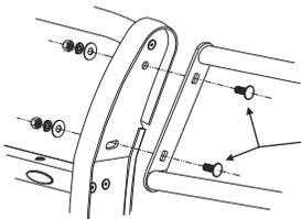
Arme primeramente los cubre-faros con el cuerpo central de la burrera utilizando los Tornillos Cab Coche de 1/2" X 1 1/4" y enseguida fije la burrera con los herrajes
