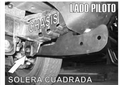
1.- Identifique los tornillos que une el soporte de la defensa con el chasis y proceda a retirar el tornillo con la llave 17 mm.
