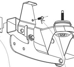
Fije el Herraje Auxiliar "C" con el soporte que une el chasis con la defensa utilizando los tornillos de 3/8" X 1 1/2"
