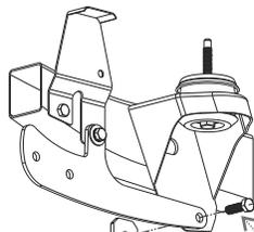
Fije el otro extremo del Herraje Principal "A" en la placa de arrastre y con la Solera Cuadrada utilizando los tornillos de 1/2" X 1 1/2"
