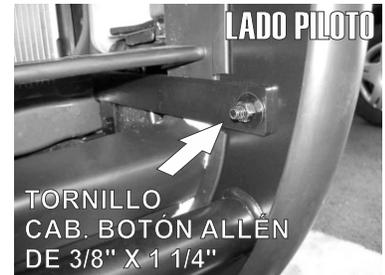
**4.-** Identifique al frente de la defensa los barrenos del soporte que une el chasis con la defensa y fije el **Herraje Auxiliar "B"** en el barreno que indica la fotografía.
