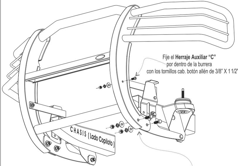
Fije el Herraje Auxiliar "C" por dentro de la burrera con los tornillos cab. botón allén de 3/8" X 1 1/2"
