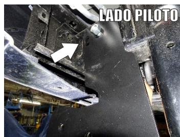
9.- Una vez introducido el Tornillo. Coloque el **Herraje Principal "A"** con su tornillería **Rondana Plana, de Presión y Tuerca Hexagonal de 1/2"**
