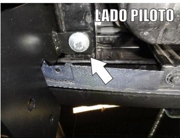
10.- Coloque el **TORN.CAB.HEX de 12x35 mm** en el segundo barreno del **Herraje Principal "A"** con su respectiva **Rondana Plana y de Presión de 1/2"**, como se muestra en las siguientes imágenes.
