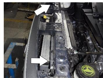
1.- Identifique la cubierta superior que protege el radiador y retire cada grapa/tornillo con cuidado. al retirar la cubierta superior identifique los barrenos existentes que están en el marco del radiador.
