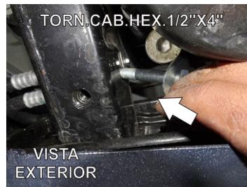
8.- Coloque en el barreno existente grande el **Torn.Cab.Hex 1/2" X 4"**, **Rondana Plana** e introduzca sacando la rosca en el otro extremo del barreno, y a si coloque el **Herraje Principal "A"**.
