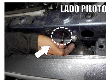
2.- Ubique los barrenos existentes Lado Piloto/Copiloto que se ubican en el marco del radiador. Coloque el Herraje Auxiliar "B" en el segundo barreno existente, a si como se muestra en las imágenes.
