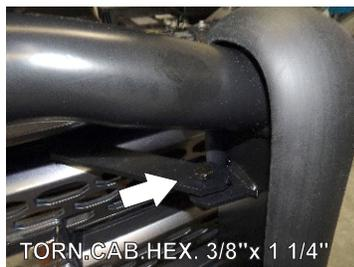
5.- En este punto tendrá colocado los **Herrajes Auxiliares B, C y D**, **OJO no ajuste en su totalidad la tornillería. Hasta no tener puesto los Herrajes Principales.**
