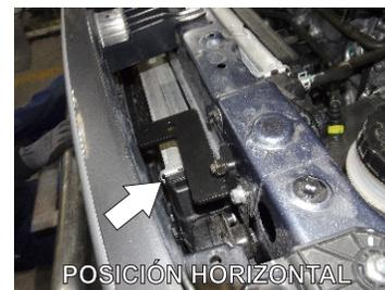
3.- Coloque el **Herraje Aux."C"** sobre el **Herraje Aux."B"** y fije con su **Rondana Plana, de Presión y Tuerca Hexagonal de 3/8"** .
