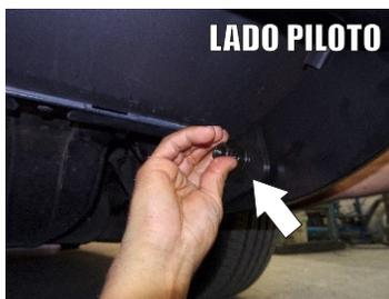
11.- Finalice colocando la **Burrera Super Bronco**. Verifique que los **Herrajes** queden por dentro y coloque la tornillería restante **Tornillo Cab. Hex. de 1/2" X 1 1/2"**, **Rondana Plana, de Presión y Tuerca Hexagonal de 1/2"**. Comience a fijar los Tornillos que Coloco en los **Herrajes Auxiliares** (Complemente el punto 11 con el punto 5)
