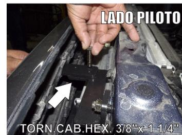
4.- Sobre el hueco de la parrilla en la parte superior Izquierda Coloque el **Herraje Auxiliar "D"**, del lado Copiloto coloque en la parte Superior Derecha.
