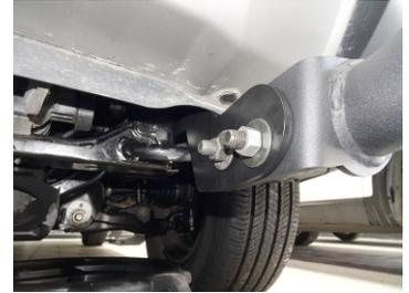
6.- Finalice colocando la **Burrera Alfa** por fuera de los **Herrajes Principales "A"** y coloque los **Tornillo Cab. Hexagonal de 1/2" x 1 1/2"**, **Rondana Plana , de Presión y Tuerca Hex. de 1/2"**. Como se muestra en las imágenes.
