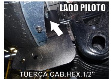
4.- Una vez introducido el Tornillo - Coloque el **Herraje Principal "A"** y finalice fijando con la **Rondana Plana, de Presión y Tuerca Hexagonal de 1/2"**.
