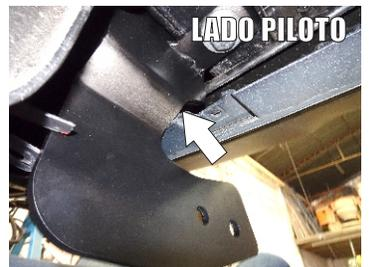
5.- Coloque el **TORN. CAB. HEX de 12x35 mm** en el segundo barreno del **Herraje Principal "A"** con su respectiva **Rondana Plana y de Presión de 1/2"**, como se muestra en las siguientes imágenes.
