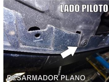
1.- Ubique en la parte inferior del vehículo los **Tornillos y Pijas Existentes** que sostienen parte de la Tolva tanto *Lado Piloto* como *Copiloto*.
