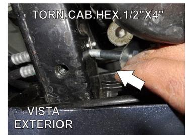
2.- Ubique los barrenos existentes que se encuentran en el brazo del chasis. *Lado Piloto/Copiloto*.
