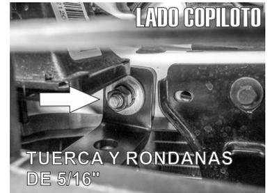
5.- Inserte el **Herraje Auxiliar "C"** y fijelo al tornillo previamente insertado, de tal manera que queden los dos barrenos restantes del herraje hacia abajo.
