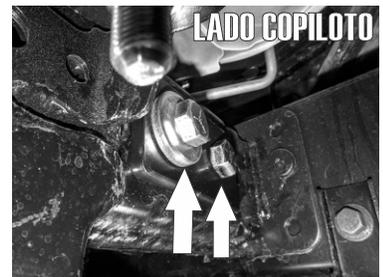
2.- Una vez descubierta la parte inferior, inserte el **Herraje Auxiliar "D"** junto con dos tornillos de 1/2" X 3 1/2" y una rondana plana cal 3/16", de lado izquierdo. Inserte el conjunto en los barrenos existentes en el chasis del Vehículo pasando y dejando las roscas por la parte interna.
