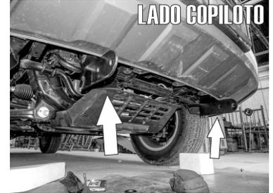
3.- Ahora presente el **Herraje Principal "A"** y montelo a los tornillos sobresalientes del chasis que se insertaron en el paso anterior, y fijelo a estos usando las rondanas de seguridad de 1/2".
