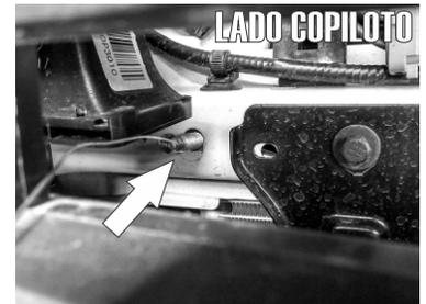
4.- Por la parte frontal del auto, a través de la parrilla, identifique el barreno existente señalado y pase un tornillo Especial con varilla soldada de 5/16" X 1", ayudándose de la guía de micro-alambre. Deje la rosca sobre saliendo hacia delante tal como se observa.
