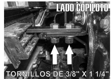
6.- Presente el **Herraje Auxiliar "B"** e insertelo por la rendija inferior de la parrilla frontal y fijelo al **Herraje Auxiliar "C"** usando dos tornillos de 3/8" X 1 1/4".
