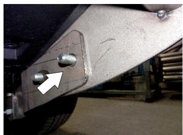
11.- Levante la Burrera Super Bronco y en seguida coloque el siguiente Tornillo Cab. Hex. de 1/2" X 1 1/2" su respectiva Rondana Plana de 1/2" y en el extremo de la rosca complementelo con la Tuerca Hex. de 1/2".
