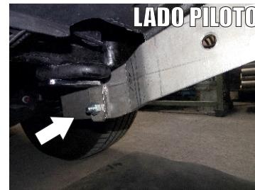
5.- Introduzca el **Tornillo Cab. Hex. 1/2" X 1 1/2"**, **Rondana Plana 1/2"** para lograr fijar el **Auxiliar "B"**, y finalice colocando **Tuerca Hexagonal de 1/2"**, sin ajustar en su totalidad el Herraje.
