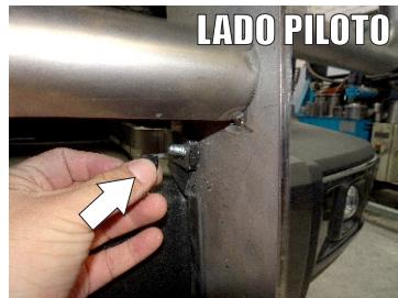
13.- Para finalizar verifique que coincidan los barrenos del Auxiliar "C" con el barreno de la placa de la burrera, como se observa en las imágenes y proceda a colocar el Tornillo Cab. Boton Allen 3/8" x 1 1/4", Rondana Plana de 3/8". y por la parte interior Rondana de Presión y Tuerca Hex. de 3/8" realice el mismo procedimiento del lado Copiloto y comiencen ajustar cada tornillo y tuerca.
