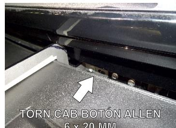
8.- Ya posicionado el Herraje Auxiliar "C", proceda a colocar los Tornillos Cab. Boton Allen 6 x 20mm, Rondana Plana y de Presión 1/4". no fije en su totalidad hasta no colocar la Burrera Super Bronco.
