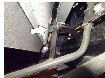
5.- Verifique que la Tuerca del Auxiliar "C", coincida con el Barreno del Herraje Auxiliar "B".
