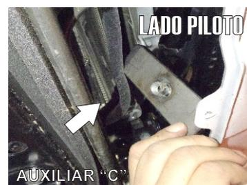
4.- Coloque el Auxiliar "C" sobre el barreno existente del canal metálico de la defensa. Posicionelo con la tuerca hexagonal hacia afuera como se muestra en las imágenes y complete colocando el Herraje Auxiliar "B", sacandolo por una de las aberturas de la facia.
