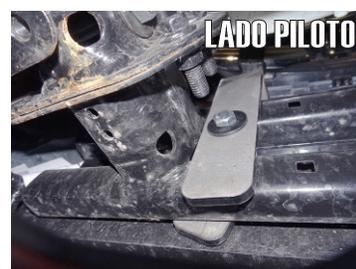
6.- Fije el Herraje Auxiliar "B", utilizando el **Tornillo Cab. Hexagonal de 3/8" x 2"**, **Rondana Plana de 3/8"**. Nota: no ajuste en su totalidad los tornillos hasta no posicionar la Burrera Super Bronco.
