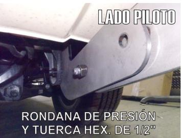
7.- Presente la Burrera sobre los barrenos de los Herrajes Principales "A" y coloque los **Tornillo Cab. Hexagonal de 1/2" x 1 1/2"**, **Rondana Plana** y en el otro extremo de la cuerda del tornillo la **Rondana de Presión y su respectiva Tuerca Hex. de 1/2"**.
