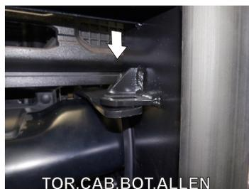
8.- Finalice presentando La Burrera Super Bronco y coloque la tornillería sobrante. Tornillo Cab. Hexagonal 1/2" X 1 1/2", Rondana Plana, de Presión y Tuerca Hex. de 1/2" en los Herrajes Principales "A" y en el Herraje Auxiliar "B" coloque el Tornillo Cab. Botón Allen 3/8" X 1 1/4", Rondana Plana en la parte Superior y en la Parte inferior su Rondana de Presión y Tuerca Hex. 3/8"
