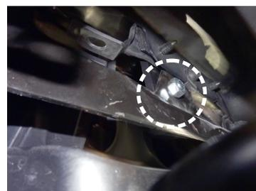
5.- En el segundo Barreno colocara el Tornillo Cab. Hexagonal 3/8" X 1 1/4", Rondana de Presión, Rondana Plana de 3/8".
