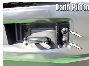
2.- Identifique los tornillos existentes al frente de la defensa de lado externo y proceda a retirarlos cuidando de mantener la solera con tuercas de la parte interna para posteriormente fijar el **Herraje Principal "A"** posicionados hacia dentro usando los tornillos retirados tal como se indica en las imágenes.
