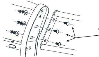
Arme primeramente los cubre-faros con el cuerpo central de la burrera utilizando los Tornillos Cab Coche de 1/2" X 1 1/4" y enseguida fije la burrera con los herrajes
