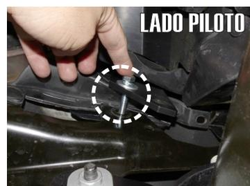
4.- Introduzca por el interior el Herraje Auxiliar "B" y posícionelo sobre los barrenos existentes. En el barreno que tenia el tornillo existente deberá de colocar el Tornillo Cab. Hexagonal de 8mm X 40mm, Rondana plana y Presión de 5/16"
