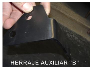
3.- En seguida por el interior ubique los dos barrenos existentes a la altura donde coloco el Herraje Principal "A". Uno de los Barrenos contara con un tornillo existente del cual deberá de retirar para colocar el Herraje Auxiliar "B".
