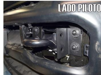
7.- Antes de ajustar en su totalidad el Herraje Principal "A", debe de cortar el Protector que retiro al inicio. Una vez realizado el corte, ajuste los tornillos y vuelva a colocar el protector ya recortado.
