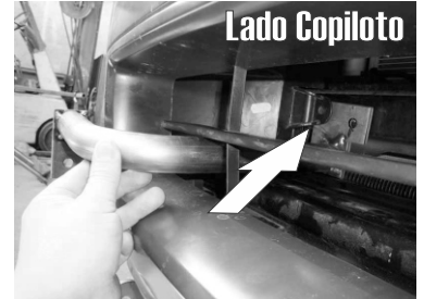
14.- En el caso de las Versiones 2015 no presentará tolvas de plástico, solo deberá introducir un Tornillo "T" con Varilla Soldada por detrás del travesaño frontal e introduzca el Herraje Auxiliar "B" por la rendija inferior fijandolo al Tornillo con las Rondanas y Tuerca de 3/8" tal como muestran las imágenes.
