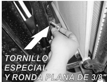
16.- Una vez instalados los Herrajes Lado Piloto y Copiloto y enseguida presente la burrera por dentro de los Herrajes Principales "A" y fijela con los tornillos de 1/2" X 1 1/2" y en la parte superior fije los Herrajes Auxiliares "B" por dentro de la burrera con los tornillos cab. botón allén de 3/8" X 1 1/4".
