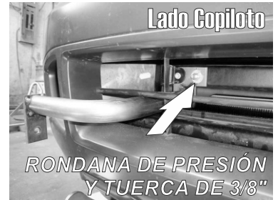
• Nivele y centre la Burrera y apriete hasta el final todos los tornillos para lograr una correcta instalación e instale las cubiertas de plástico y grapas que retiro con anterioridad ( si fuera el caso ).
