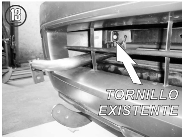
15.- Fije el otro barreno del Herraje con el Tornillo Hexagonal de 6mm X 25mm y Rondanas de 1/4".
