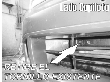
11.- Ubique las tolvas laterales de plástico por las rendijas inferiores de la defensa y retire el tornillo que sujeta dicha tolva.
