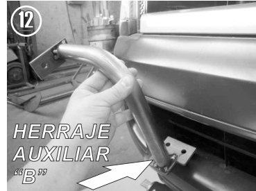
13.- Después fije manualmente el Herraje Auxiliar "B" con el tornillo que retiro con anterioridad e inserte un tornillo especial entre la defensa y el radiador y fijelo de igual forma con el otro barreno del Herraje Aux. "B" utilizando las rondanas y tuerca de 3/8".
