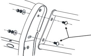
Arme primeramente los cubre-faros con el cuerpo central de la burrera utilizando los Tornillos Cab Coche de 1/2" X 1 1/4" y enseguida fije la burrera con los herrajes
