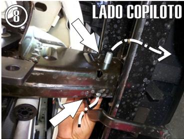
8.- Identifique los barrenos laterales del chasis e inserte de adentro hacia fuera un tornillo de 1/2" X 3 1/2".
