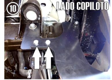
10.- Termine de Fijar los dos Herrajes instalados con los Tornillos de 3/8" X 1 1/4".
