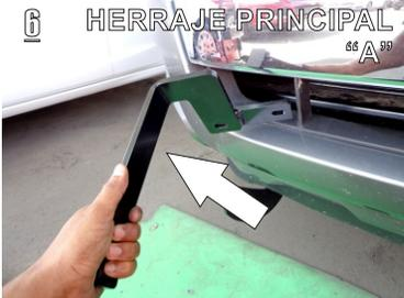
6.- Introduzca el Herraje Principal "B" (lado piloto) por la parte frontal de la defensa torciendolo un poco de manera que entre por la rendija inferior, fíjelo al barreno que esta en el chasis con el Tornillo Cab. Hex. de 10mm X 45mm
