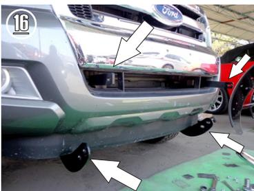
16.- Una vez instalados los Herrajes Lado Piloto y Copiloto y enseguida presente la burrera por dentro de los Herrajes Principales "A" y fíjela con los tornillos de 1/2" X 1 1/2" y en la parte superior fije los Herrajes Auxiliares "B" por dentro de la burrera con los tornillos cab. botón allén de 3/8" X 1 1/4".
