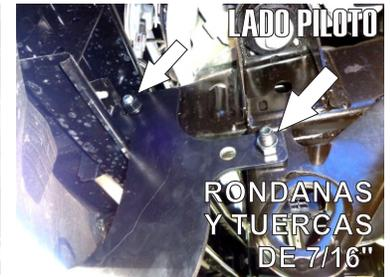
**NOTA:** Para las versiones 2013 - 2014 de este modelo el **Herraje Principal "A"** (Lado Copiloto) deberá ser instalado de Igual forma que el Lado Piloto de los anteriores pasos y saltar al paso numero 11 para continuar con la Instalación.
