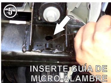
5.- De Lado Copiloto del Vehículo ubique el barreno que esta en la parte inferior del soporte del Chasis y proceda a insertar una Guía de Micro-Alambre del tal modo que salga del lado posterior del Chasis.
