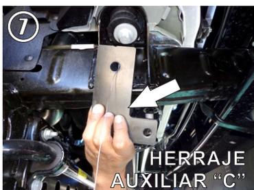
7.- Presente el **Herraje Auxiliar "C"** sobre el Tornillo insertado, quite la Guía de Micro-Alambre y fijelo con las Rondanas y Tuerca de 7/16".
