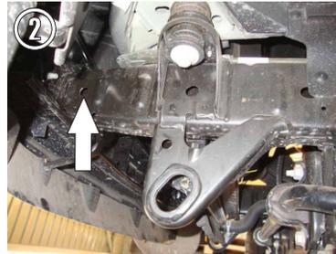
2.- Identifique los barrenos laterales del chasis e inserte de adentro hacia fuera un tornillo de 1/2" X 3 1/2".
