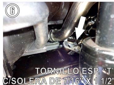
6.- Sujete un Tornillo "T" con Solera Soldada de 7/16" X 1 1/2" y saquelo por la parte de afuera del Chasis.
