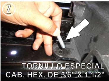
7.- De nuevo por la parte interna del chasis inserte el tornillo especial con Varilla Cab. Hex. de 5/16" X 1 1/2" sacando la rosca del tornillo por la parte frontal de la defensa y el Herraje Principal "B", fíjelo con las Rondanas y Tuercas de 5/16"
