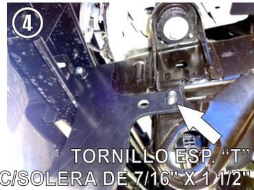
4.- Inserte un Tornillo "T" con Solera Soldada de 7/16" X 1 1/2" en la parte posterior con el gancho de arrastre del vehículo y fije el Herraje con las Rondanas y Tuercas de 7/16".
