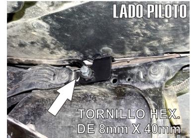
8.- Por la parte interna de la defensa delantera busque el tornillo existente por encima del chasis que sujeta la varilla de soporte y proceda a retirarlo
