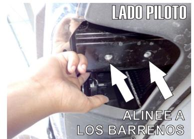
5.- Si el vehículo no cuenta con ganchos de arrastre deberá hacer un corte en la parte inferior de la defensa marcada en la imagen para descubrir el chasis y proceder con la instalación.
