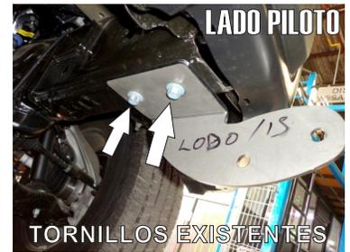
4.- Jale el hule del gancho para retirarlo y posteriormente presente y fije el **Herraje Principal "A"** sobre los barrenos y use los tornillos antes retirados para sujetarlo en el lugar del gancho retirado.
