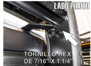
10.- Por la parte externa aconsejamos apoyarse introduciendo un desarmador plano que sirva como guía para sacar el **Herraje Auxiliar "B"** de adentro hacia afuera, tal como se muestra.
