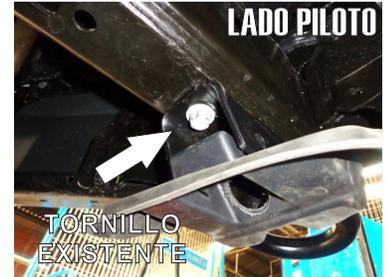
2.- Después retire los ganchos delanteros quitando el tornillo frontal que lo sujeta al chasis usando la matraca con extensión.
