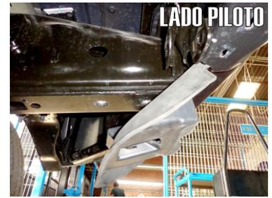
3.- Afloje el segundo tornillo posterior que sujeta el gancho y safelo moviendo el gancho hacia tras y hacia abajo. Después retire por completo el tornillo cuidando de no desalinear el herraje interno del chasis para poder insertar los tornillos de nuevo después.
