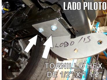
7.- Presente el **Herraje Principal "A"** por debajo del chasis y fíjelo con el **Herraje Auxiliar "B"** insertado; utilizando los Tornillos de 1/2" X 1 1/2".
