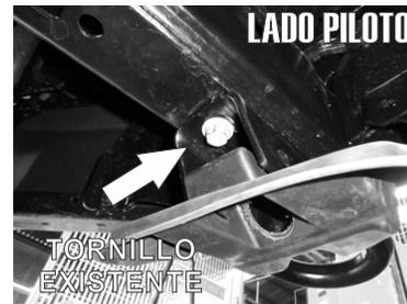
2.- Después retire los ganchos delanteros quitando el tornillo frontal que lo sujeta al chasis usando la matraca con extensión.
