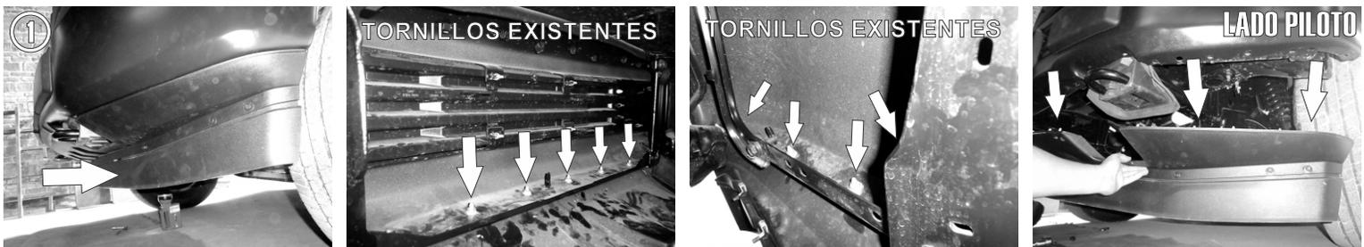
1.- Primeramente deberá quitar el faldón plástico delantero del vehículo para proceder con la instalación retirando todos los tornillos por la parte interna que lo sujetan y retírelo por completo.
