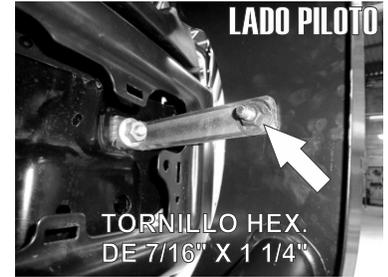
9.- Insterte el Herraje Auxiliar "B" en el tornillo desocupado en el modo que se muestra y fíjelo a este usando la tuerca retirada.
