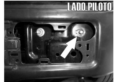
8.- Por la parte frontal de la defensa delantera desengrape las tapas laterales que se señala en las imágenes y retire la tuerca del tornillo exterior que se encuentra en ese lugar.
